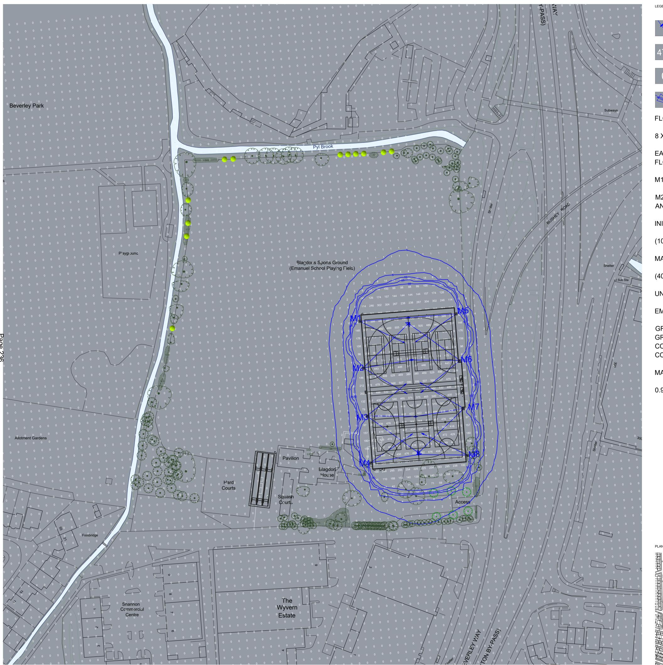
LUX CONTOUR (50 LUX / 25 LUX / 15 LUX / 5 LUX / 1 LUX)
